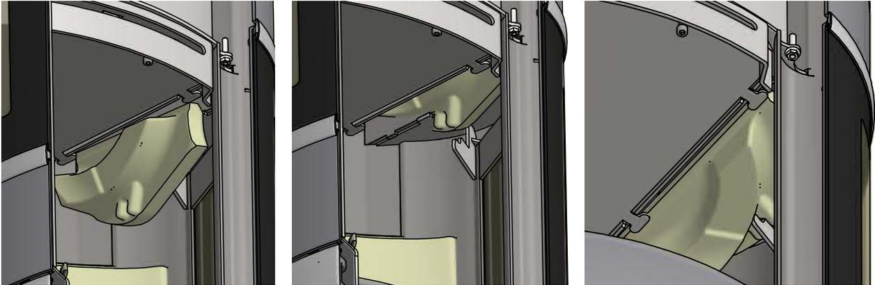
Cuando las placas de vermiculita 1-4 estén colocadas, se deberían ver así. Asegúrese de que los dos deflectores estén colocados idénticamente
