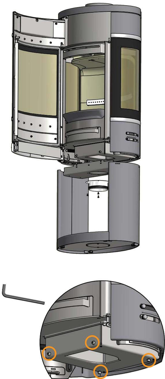
Una vez colocada la estufa en la base, se deben volver a montar los cuatro tornillos
