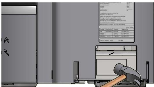
Utilice un taladro con una broca de  $\varnothing 6$  mm o unos alicates de corte para quitar las placas que se muestran en la ilustración
