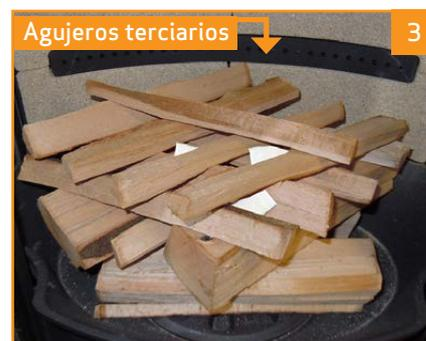
Coloque el material de encendido entre los palos superiores
